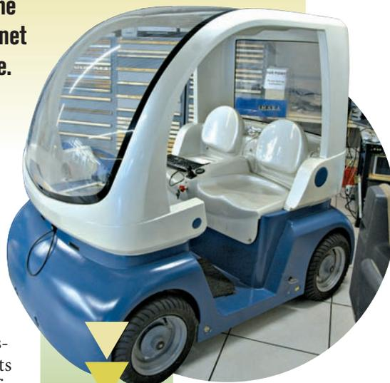
**Un véhicule capable de rouler en convoi, relié aux autres voitures par des communications sur IPv6.**
